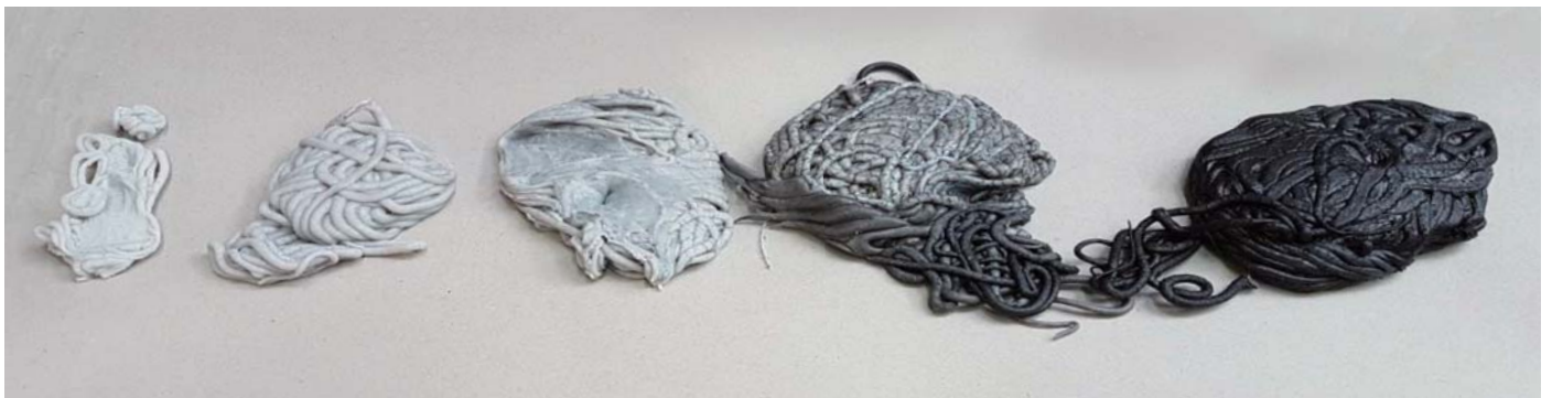
最右部分：PA66材料 中间部分：清洗后第一次射出的DREYCHEM 最左部分：清洗完毕后的带出的材料
